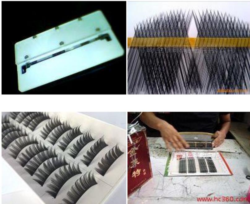
圖 4. 15. 製作眼睫毛的模具、網狀眼毛將兩片合成一片的眼睫毛、扇狀眼睫毛及半成品
